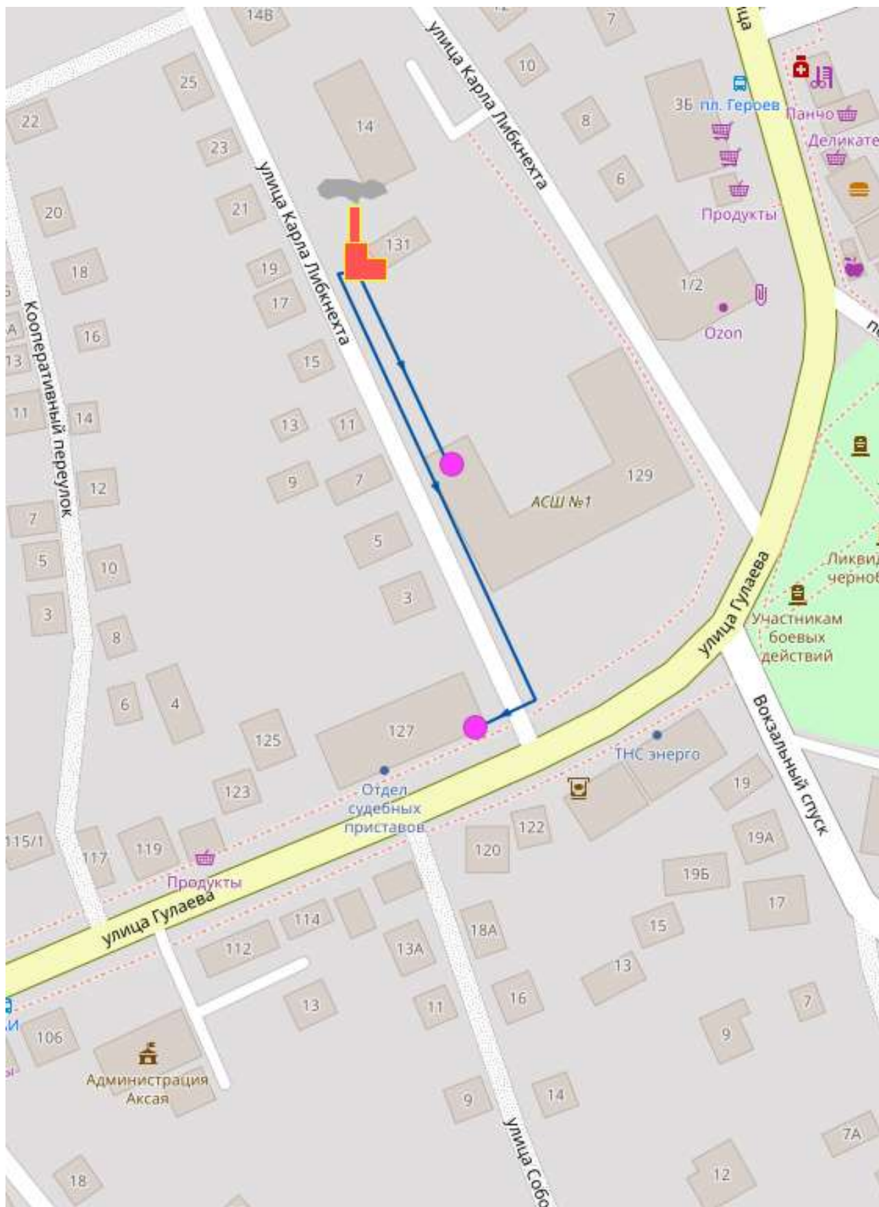
Рисунок 11 Карта (схема) тепловых сетей в зоне действия котельной № 7
