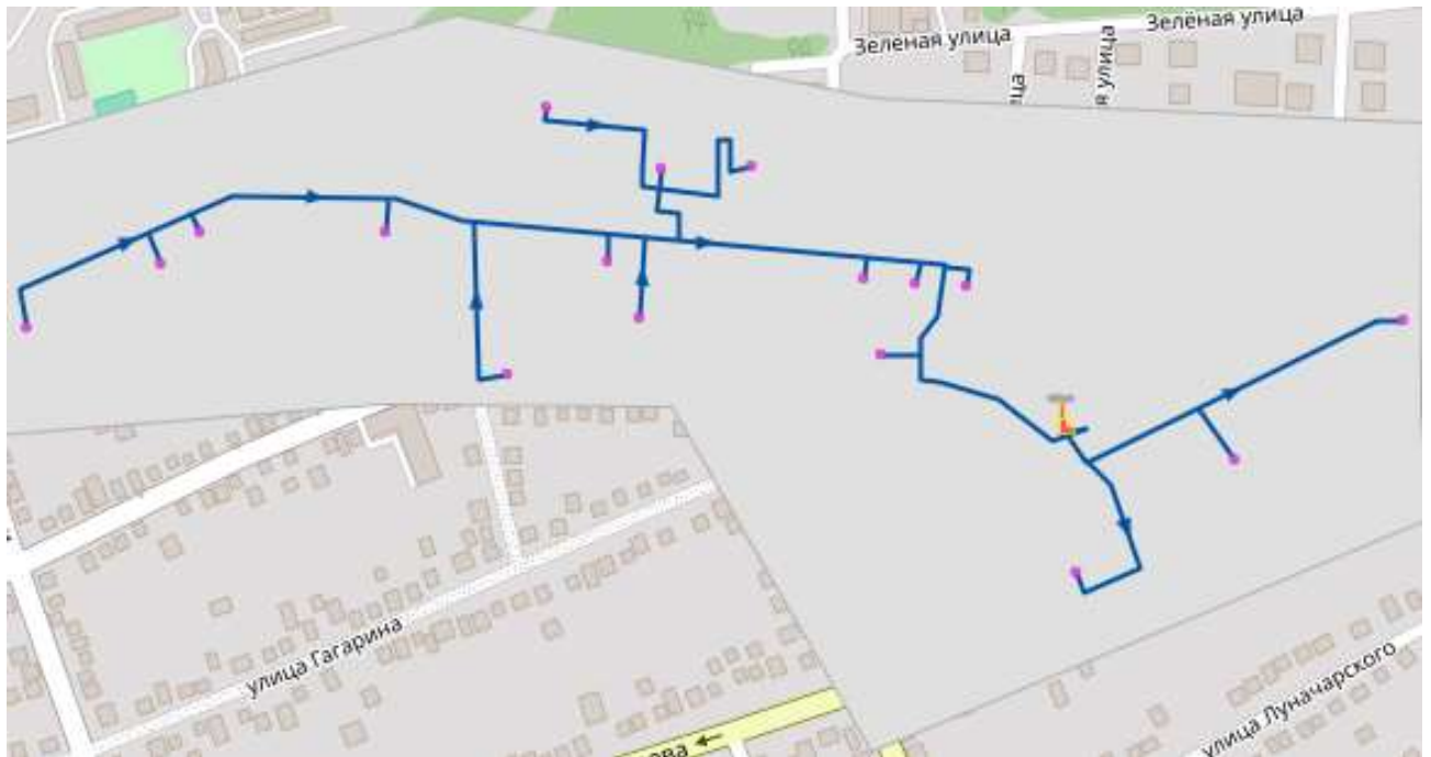
Рисунок 23 Существующая зона действия системы теплоснабжения и источника тепловой энергии котельной № 7 ООО «ДТС»
